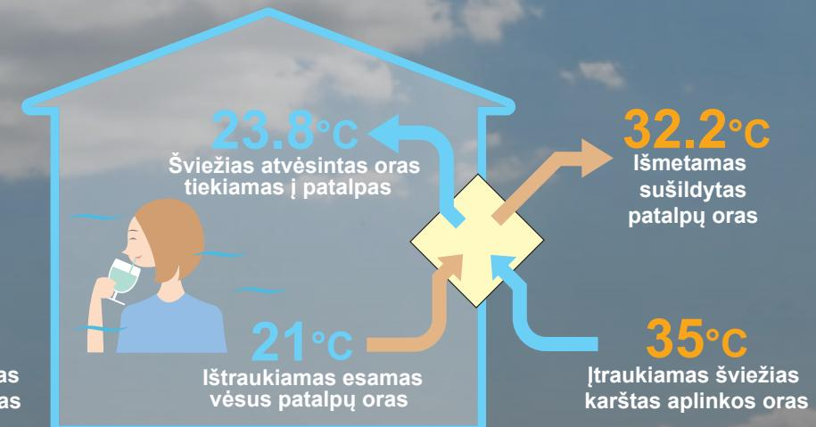
$$\text{Tiekiamo į patalpas šviežio oro temp. (}^{\circ}\text{C}) = \frac{\text{Aplinkos oro temp. (}^{\circ}\text{C)}}{\text{Temp. (}^{\circ}\text{C)}} - \left\{ \frac{\text{Aplinkos oro temp. (}^{\circ}\text{C)}}{\text{Patalpų oro temp. (}^{\circ}\text{C)}} - \frac{\text{Patalpų oro temp. (}^{\circ}\text{C})}{\text{Temp. mainų efektyvumas (\%)}} \right\} \times \text{Temp. mainų efektyvumas (\%)}$$
